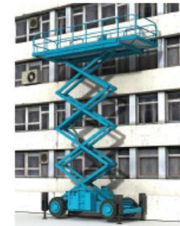
Piattaforma di lavoro mobile elevabile verticale a pantografo
